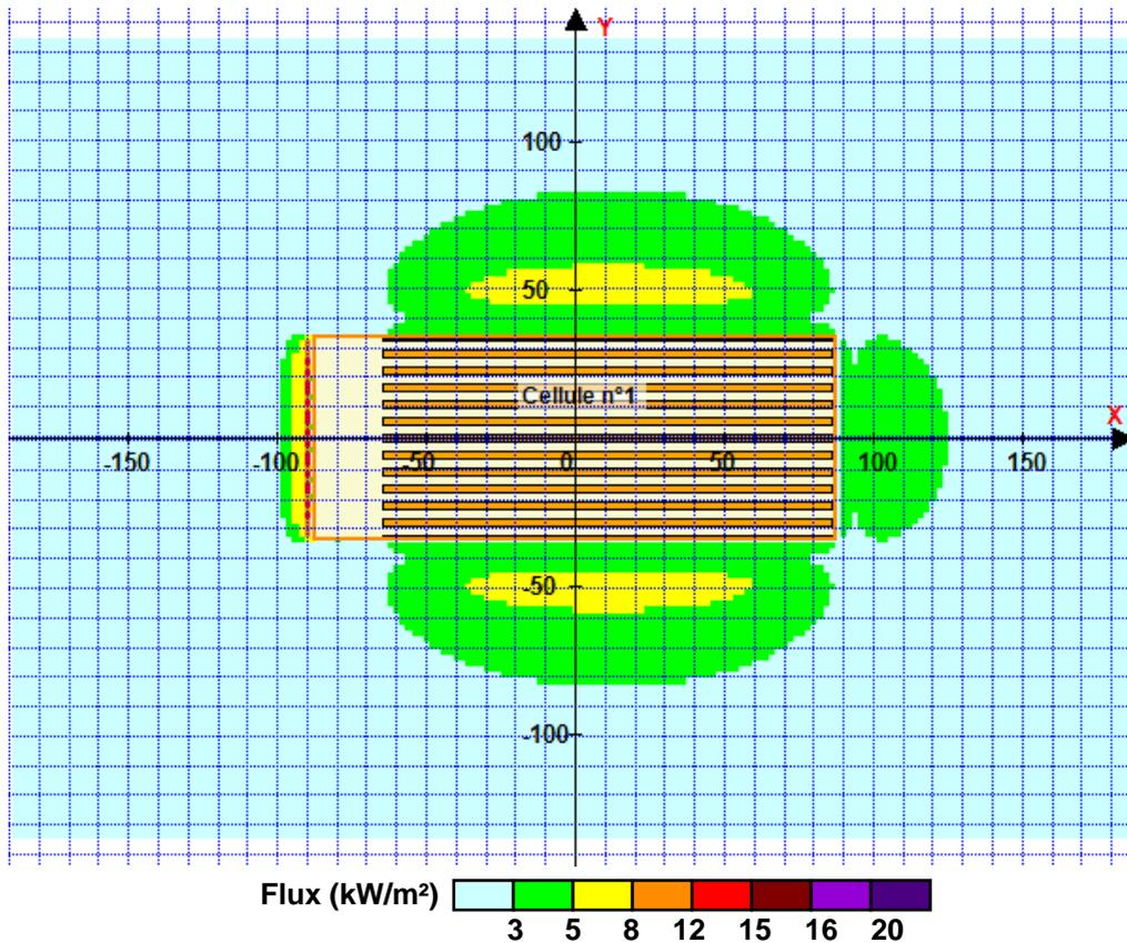
Pour information : Dans l'environnement proche de la flamme, le transfert convectif de chaleur ne peut être négligé. Il est donc préconisé pour de faibles distances d'effets comprises entre 1 et 5 m de retenir une distance d'effets de 5 m et pour celles comprises entre 6 m et 10 m de retenir 10 m.
